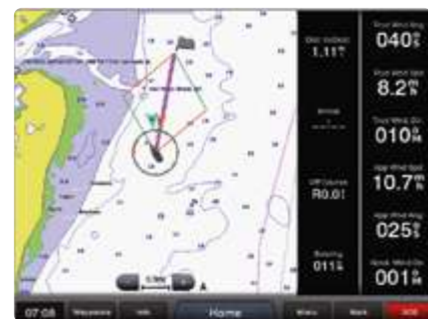
Fonctions Voile : laylines, COG, affichage simultané des données de vent réel/apparent, etc. Sailing features: laylines, COG, true wind/apparent wind data displayed at the same time, etc.
