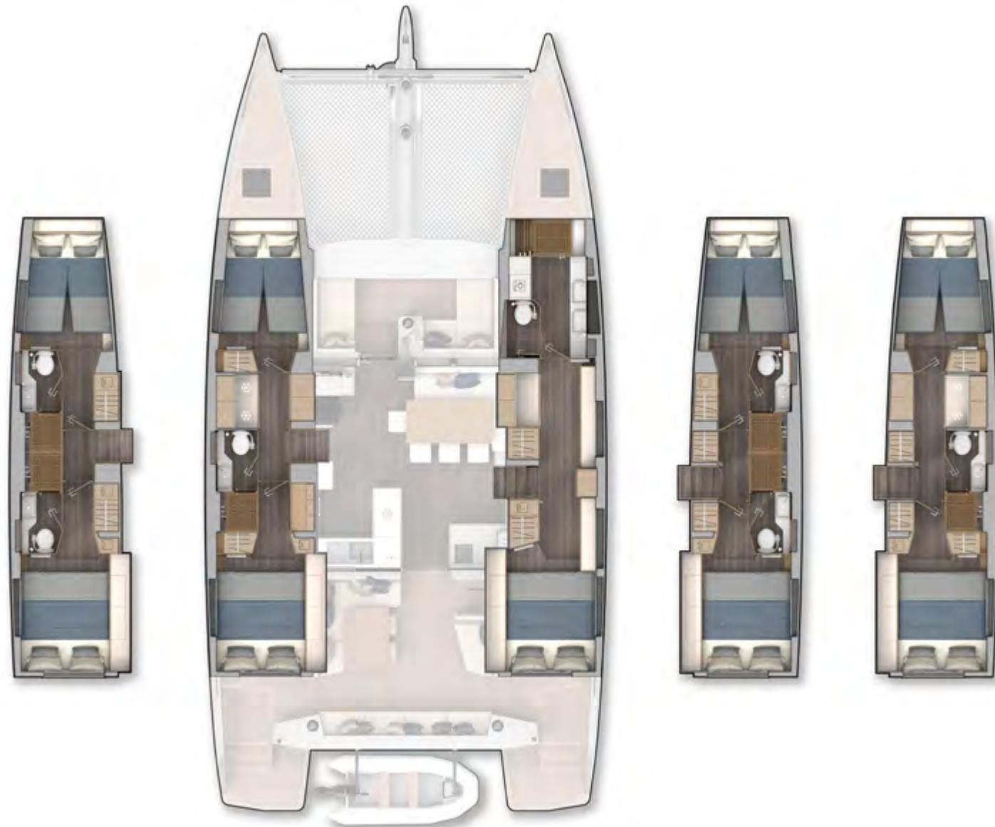
Différentes dispositions d'aménagements intérieur sont proposées, par association de deux possibilités sur la coque bâbord et de trois possibilités sur la coque tribord. Cela permet de compter de 6 à 10 couchages et d'offrir dans tous les cas un haut niveau de confort à l'équipage.
