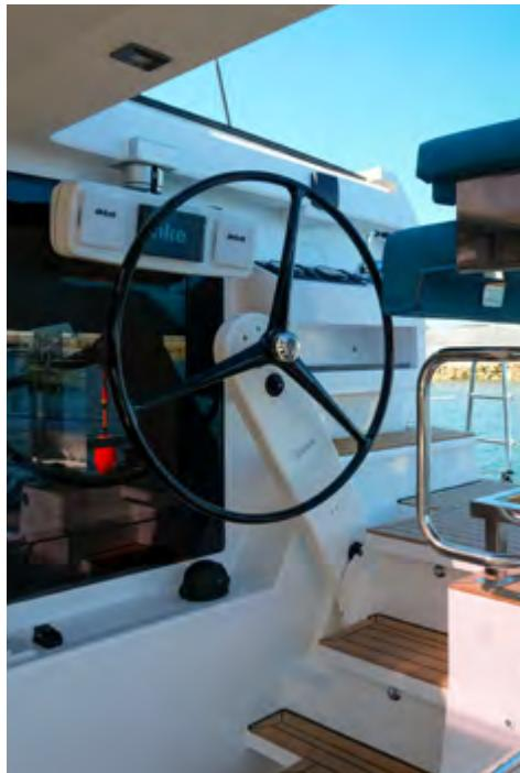
Le poste de barre extérieur de l'Explocat 52 est équipé d'un système de barre à roue pendulaire. Ce dispositif permet de barrer soit en position basse à l'abri du cockpit, soit en hauteur pour les manœuvres et la navigation par beau temps.
